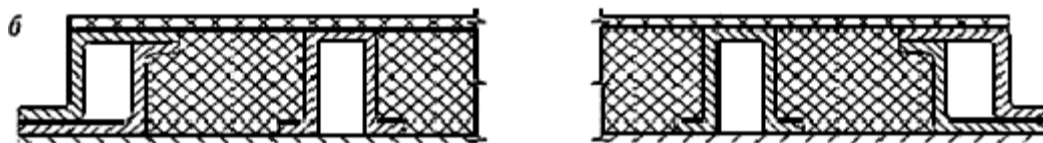
Полотно с двумя стальными листами, стальными профилями коробчатого сечения и сотовым заполнением
